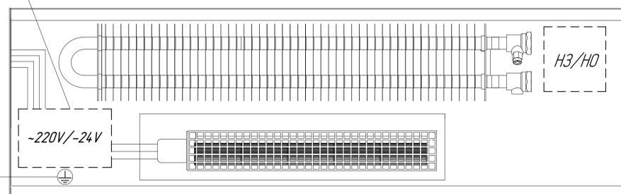
Конвектор с вентилятором DC24V
