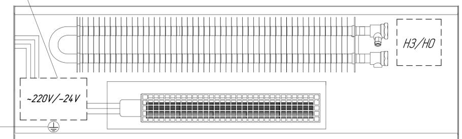
Конвектор с вентилятором DC24V
